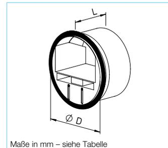
Die automatischen Volumenstrom-Konstanthalter VKH sind die überzeugende und preisgünstige Lösung zur Gewährleistung eines konstanten Volumenstromes.
