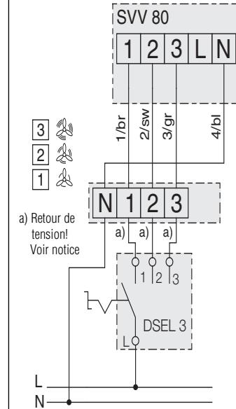
Bei Verwendung mit DSEL3 darf keine Beleuchtung mit angeschlossen werden
