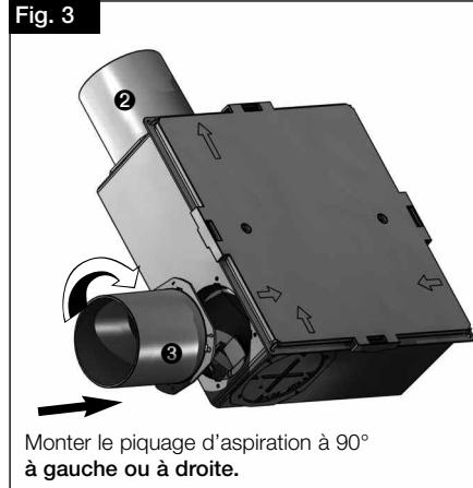
Possibilité de monter jusqu'à trois raccords d'aspiration (voir Fig. 4).
