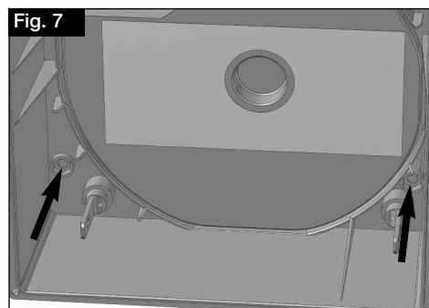
Percer les logements de vis pour la fixation murale (**sans support de montage**) ( $\varnothing$  6 mm).
