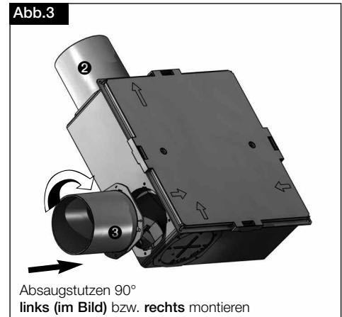
Bis zu drei Absaugstutzen können montiert werden (siehe Abb 4).
